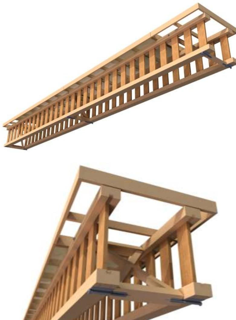
Рис. 2. Конструктивная схема плиты с наклонными диафрагмами и с основными ребрами в виде двутавровых балок с прерывистой стенкой из вертикально поставленных досок
