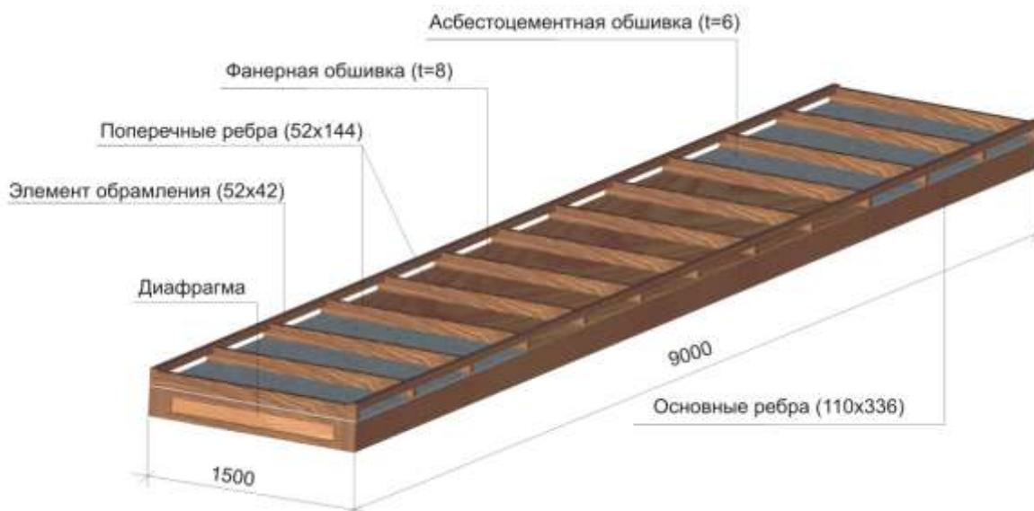
Рис. 1. Конструктивная схема плиты марки ПФР 9-1,5АIV с обшивкой, комбинированной из фанеры и плоских асбестоцементных листов
